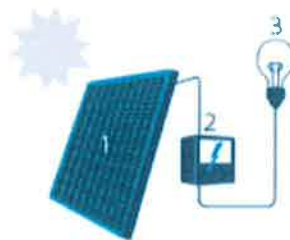
1. Zonnepaneel | 2. Omvormer | 3. Elektrische toestellen
